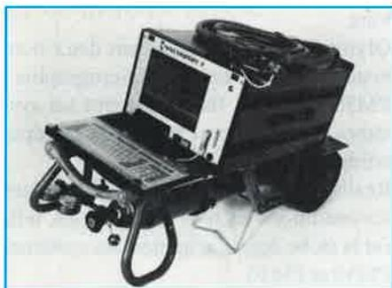
L'appareil recherche une nuance ou confirme la nuance affichée en explorant sa banque de données qui peut être créée et modifiée selon les besoins particuliers. Autre nouveauté : le spectroflame Modula, un spectromètre d'émission optique à plasma à couplage inductif pour l'analyse élémentaire simultanée et séquentielle.
