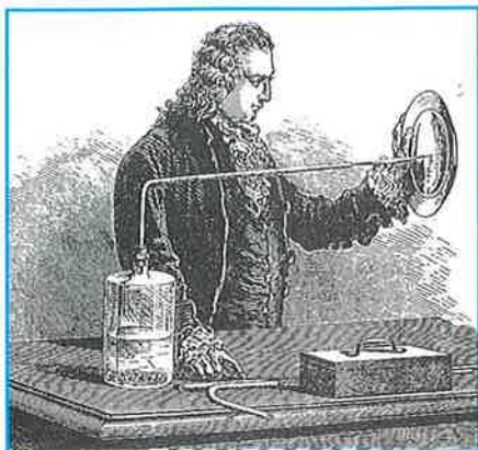
Figure 1 - Expérience de Macquer montrant que la combustion de l'hydrogène produit de l'eau (C. Bailleux, P. Clément., L'hydrogène révolutionnaire , EDF).
