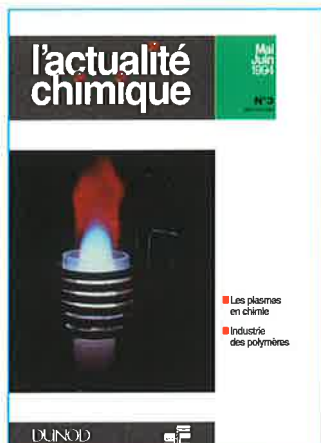
Torche plasma pour analyse dans le cas d'un panache d'argon ensemencé au lithium.
