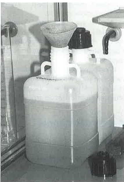
Après utilisation, ces solvants sont conservés dans des bidons en polypropylène placés sous une sorbonne en tenant compte des incompatibilités.
