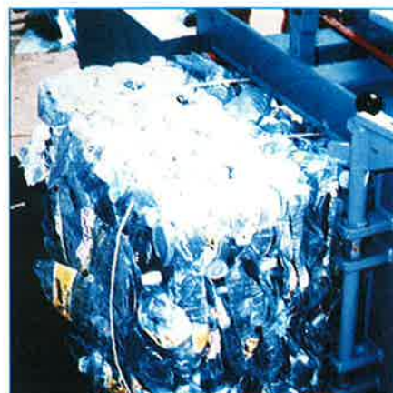
Photo 4 - Balle de bouteilles compactées sortant de la presse (photo Recy PVC).
