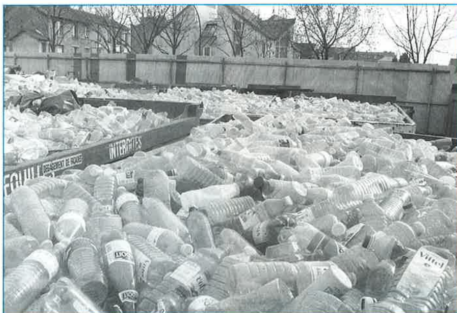
Photo 3 - Expérience de collecte sélective. Chaque benne 15 m 3 représente quelque 7 à 410 000 bouteilles qu'il faudra encore trier une à une ... mais seulement 400 kg de plastiques. La garantie de reprise Valorplast/Éco-Emballages en donnera une fois transportées, triées, mises en balles... à peine 600 francs.
