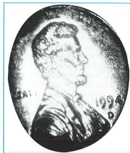
Photo 1 - Exemple d'application des polymères photoréfractifs : l'enregistrement holographique. Restitution de l'image d'une pièce de 1 cent US enregistrée sous la forme d'un hologramme 3D dans le polymère photoréfractif. L'enregistrement et la lecture de l'hologramme sont réalisés avec une diode laser (9 mW) émettant à 675 nm (couleur rouge).
