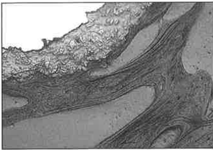
Figure 8 - formation d'un tissu osseux mature, chez l'homme (6 mois). Microscopie optique par réflexion. Gris clair : zone médullaire, gris foncé : tissu nouvellement formé, zone parsemée de points : revêtements ( e \sim 130 \mu ), zone blanche : métal. On distingue les lamelles du tissu osseux.
