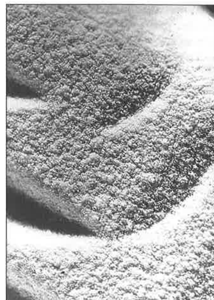
Figure 6 - Revêtement de l'hydroxyapatite : détail montrant l'état de surface conçu pour optimiser la fixation de l'os.
