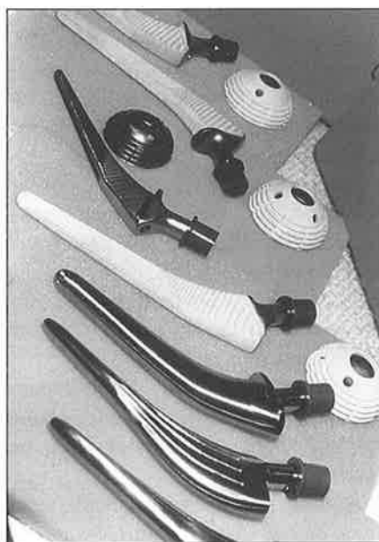
Figure 5 - Quelques modèles de prothèses de la hanche, tige et cotyle ; de nombreux exemplaires sont revêtus d'une céramique en hydroxyapatite.
