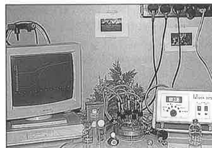
Figure 1 - L'odorimètre, un nez électronique mis au point à l'ENSCT.
