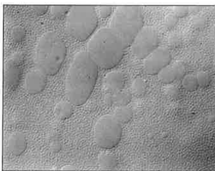
Figure 4 - Photo (microscopie optique) d'une émulsion monodisperse concentrée à environ 80 % (diamètre 1,6 µm) portée à une pression osmotique de 0,6 atm. Dans ces conditions, on observe la croissance de grosses gouttes qui consomment les petites autour et qui cessent de coalescer lorsqu'elles se rencontrent (voir texte).
