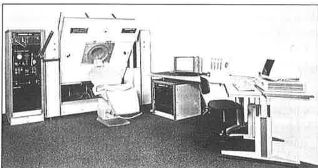
Figure 3 - Appareillage d'un tomomatiq SPECT dédié cerveau qui comprend une gamma-caméra et un système informatique pour le traitement des images réalisées en coupes tomographiques.
