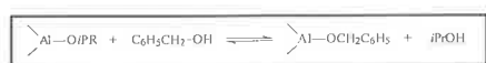
Schéma 2 - Réaction de transfert entre un isopropylate d'aluminium et une molécule d'alcool benzylique. Cette réaction d'échange permet de transformer la nature des centres actifs.
