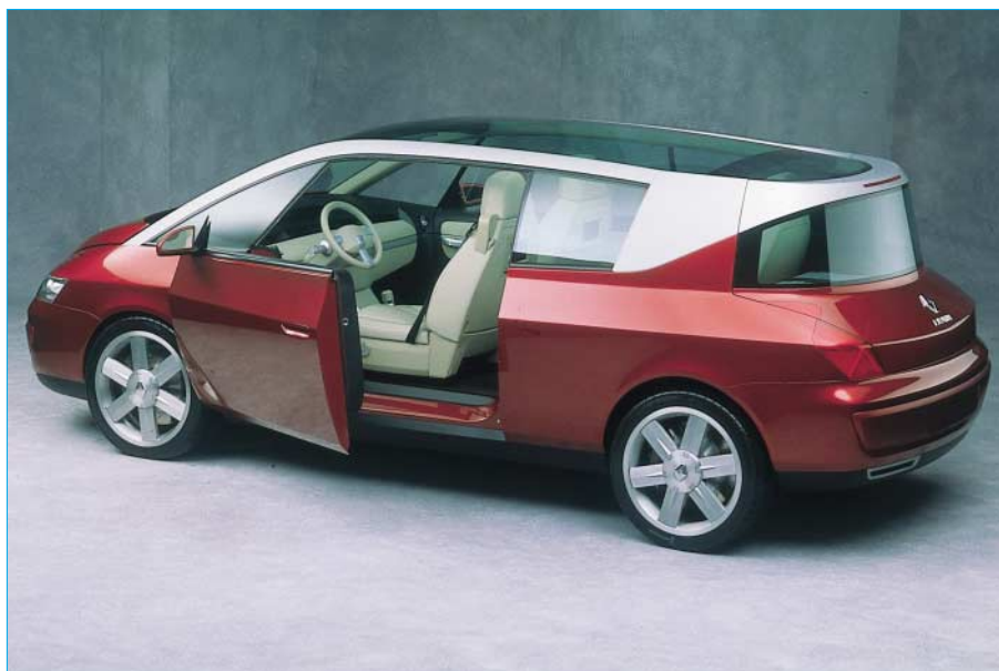
Figure 3 - Un véhicule innovant - l'Avantime - qui fait appel à des matériaux « nouveaux » : carrosserie plastique (SMC), toit en verre, aluminium...
