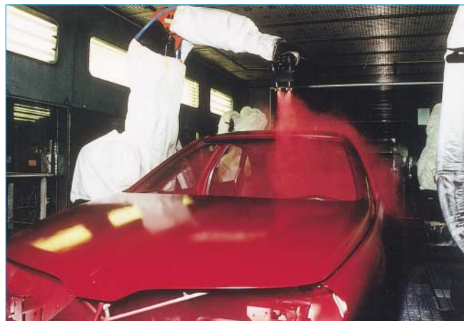
Figure 2 - Application automatique d'une base colorée (Renault, Sandouville).
