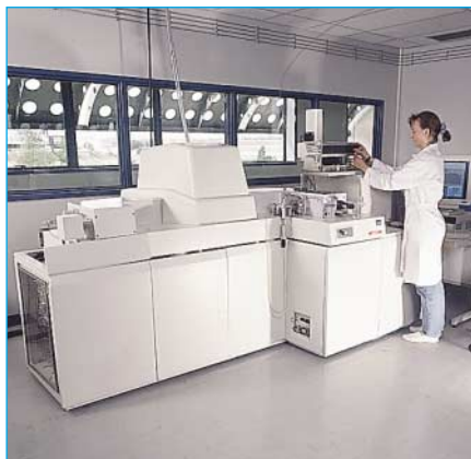
Photo 1 - HRGC-HRMS pour l'analyse des dioxines et furanes.
