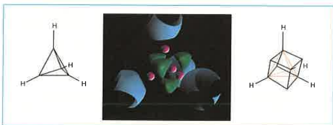
Figure 7 - Liaisons dans B_4H_4 : à gauche, squelette supposé ; au centre, visualisation ELF ; à droite, squelette moléculaire résultant de l'analyse ELF.
