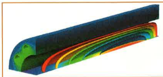
Figure 2 - Distribution de température calculée dans la chemise de réchauffage et dans le cœur d'un réacteur de reformage à la vapeur.
