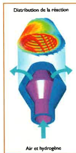
Figure 3 - Distribution de la réaction dans un brûleur catalytique. Une asymétrie dans la paroi poreuse du brûleur induit des non-uniformités dans les performances du procédé.
