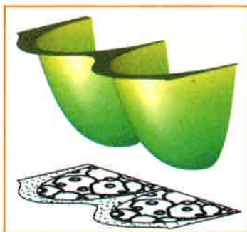
Figure 5 - Répartition de la concentration en oxygène autour et à l'intérieur de deux agglomérats du catalyseur dans une cathode de pile à combustible.
