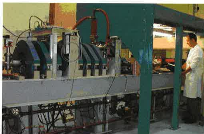
Fig. 1 : Une nouvelle installation pour la radiolyse pulsée. L'accélérateur linéaire (LINAC) d'électrons de 10 MeV délivre des impulsions dont on peut choisir la durée entre 3 ns et 5 ns qui traversent une cellule d'irradiation dans laquelle les échantillons liquides sont radiolysés. Les espèces créées sont détectées en absorption ou en fluorescence dans le domaine spectral UV-visible. L'énergie des électrons permet de mener des études à haute température et haute pression.
