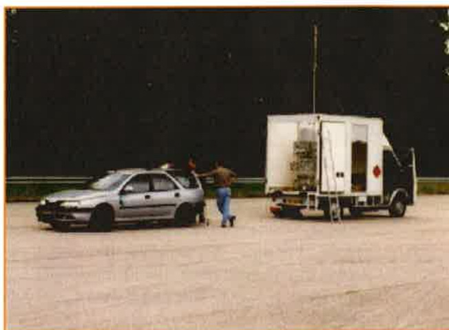
Figure 2 - Système de recharge en hydrogène liquide de Feveo.
