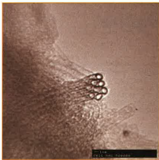
Figure 1 - Coupe d'un faisceau de nanotubes monoparoi (vue microscopie électronique à transmission). (Source : http://cnst.rice.edu/images ).
