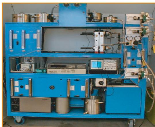
Figure 4 - Photo du banc de tests TEC pour caractérisation de pile à combustible pour stack (d'après [5]) de 50 W à 1 KW jusqu'à 140 °C avec purge à azote et circuit H<sub>2</sub>. Le banc de test comprend les éléments suivants :
