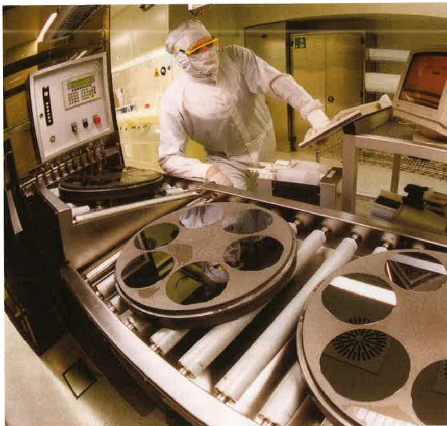
Une utilisation du silicium ultrapur : les tranches de Si de 150 mm pour applications en microélectronique sont soumises à un contrôle qualité sévère après polissage. (Photo Wacker Siltronic).
