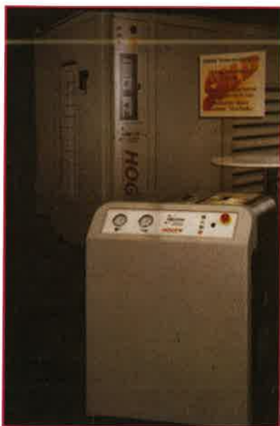
Figure 3 - Électrolyseur Hogen ® 40 (Proton Energy Systems).
