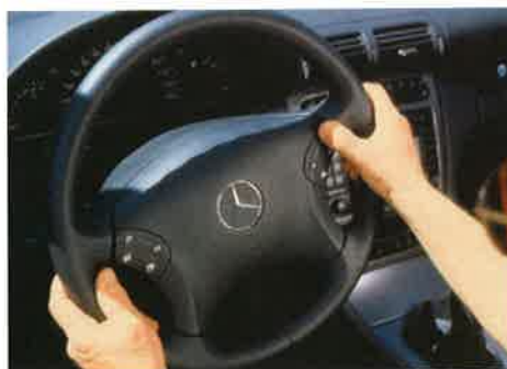
Une utilisation du silicone : les conducteurs de Mercedes Classe C et E commandent à partir du volant poste radio, téléphone et système de guidage grâce à un dispositif multifonctionnel, réalisé en Elastil LR, le caoutchouc liquide de Wacker. (Photo Wacker).
