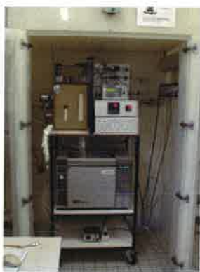
Réacteur Fischer Tropsch fonctionnant en mode transitoire.
