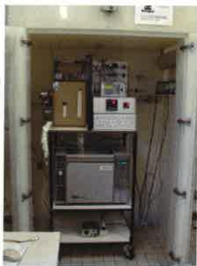
Réacteur Fischer Tropsch fonctionnant en mode transitoire.
