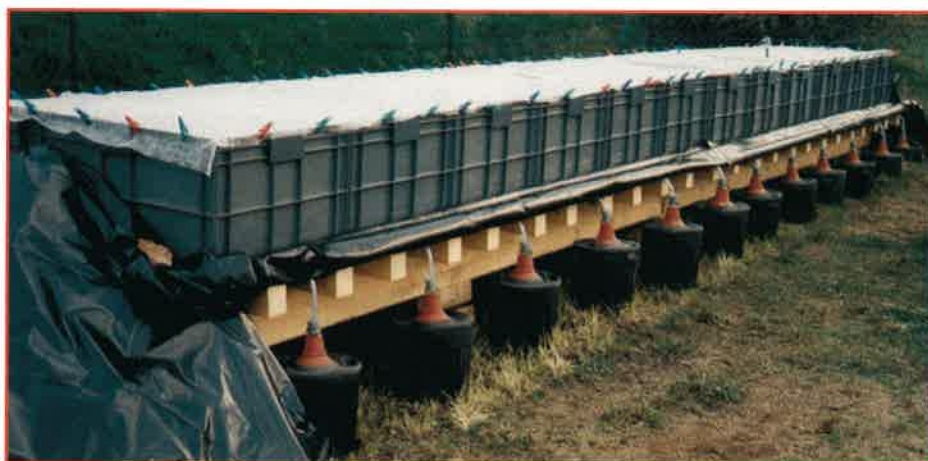
Etude de la phytodégradation des HAP dans des sols industriels (dispositifs lysimétriques).
