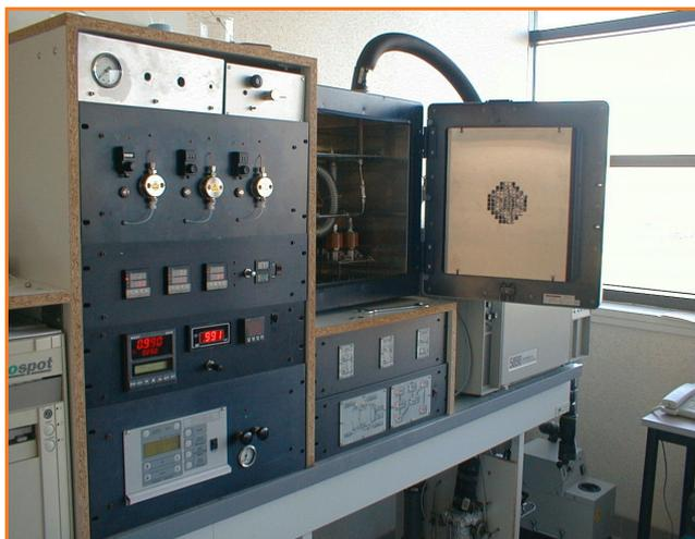
Figure 3 - Réacteur solide/gaz de laboratoire.
