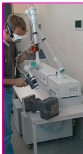
Figure 1 - Laser Nd:YAG (type SAGA 220/10) avec quatre longueurs d'onde, utilisé dans l'étude des décolorations des pigments historiques sous rayonnement laser.
