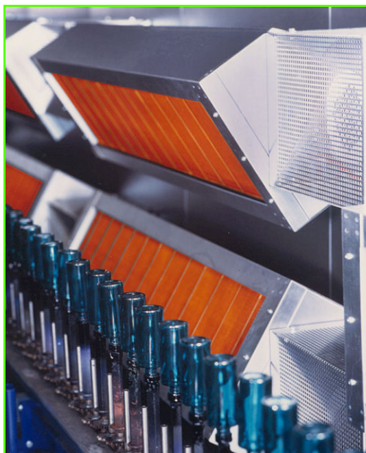
Figure 2 - Tunnel de séchage de peinture équipé de panneaux radiants catalytiques (avec l'aimable autorisation de la société Sunkiss).
