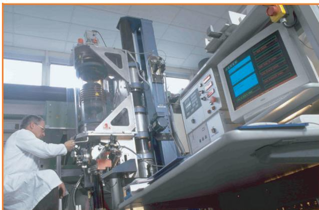
Figure 3 - Réacteur de croissance SiC et poste de supervision.
