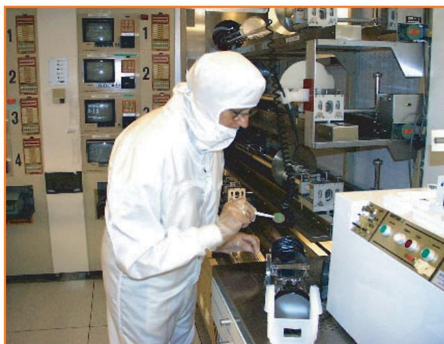
Figure 6 - Vue d'une partie de la zone « traitements thermiques » en salle blanche : manipulation d'un substrat SiC.
