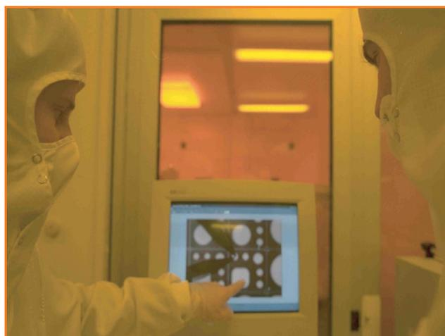
Figure 7 - Contrôle dimensionnel des diodes en cours de process technologique.
