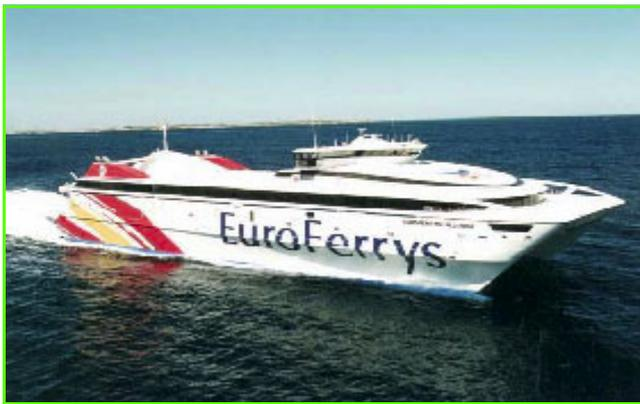
Figure 8 - Navire rapide de 101 mètres type auto Express (Pacifica d'Euroferry) construit par Austal avec structure légère en alliage d'aluminium (d'après [12]).
