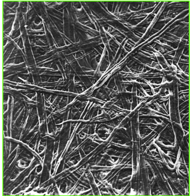
Figure 4 - Image au microscope électronique d'une surface de papier d'environ 1 mm 2 .
