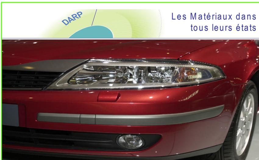
Figure 4 - Un exemple de multimatériaux : l'avant de la Laguna II de Renault (aile en alliage de polymère, capot en aluminium, phares en polycarbonate, peau de bouclier en polypropylène, sur poutre en acier à très haute limite d'élasticité).
