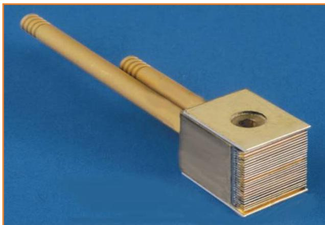
Figure 7 - Structure de diodes laser de puissance à empilement de barrettes opérant en régime quasi-continu (200 µs, 100 Hz). (Thales Laser Diodes).
