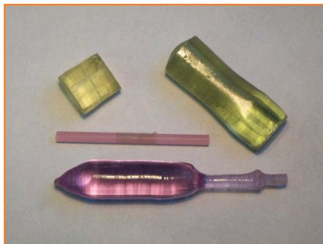
Figure 9 - Exemples de cristaux pour laser élaborés à partir de l'état fondu par la méthode Czochralski. Cristaux verts :  $Ca_2Al_2SiO_7$  dopés  $Pr^{3+}$  ; cristal rose-violet :  $Ca_4GdB_3O_{10}$  dopé  $Nd^{3+}$ . Au centre de la photo, barreau laser de  $LaMgAl_{11}O_{19}$  dopé  $Nd^{3+}$ , usiné à partir d'un cristal tel que ceux présentés ici. (Document LCAES-ENSCP).
