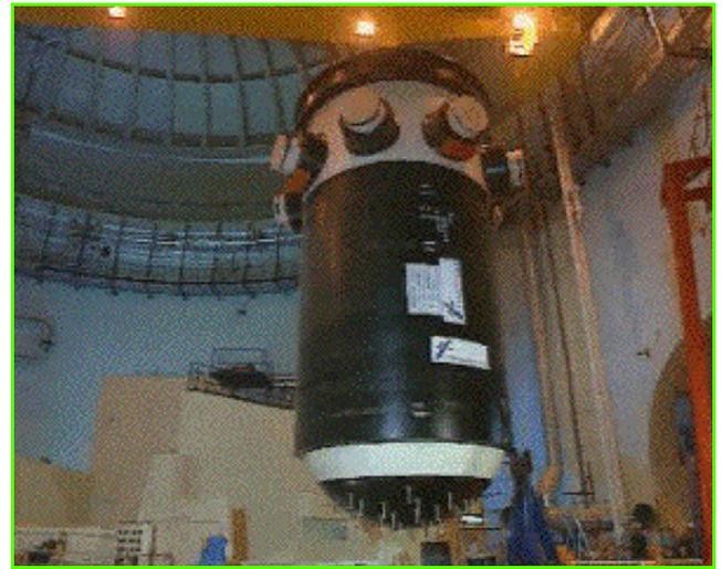
Figure 2 - Cuve d'un réacteur à eau sous pression.
