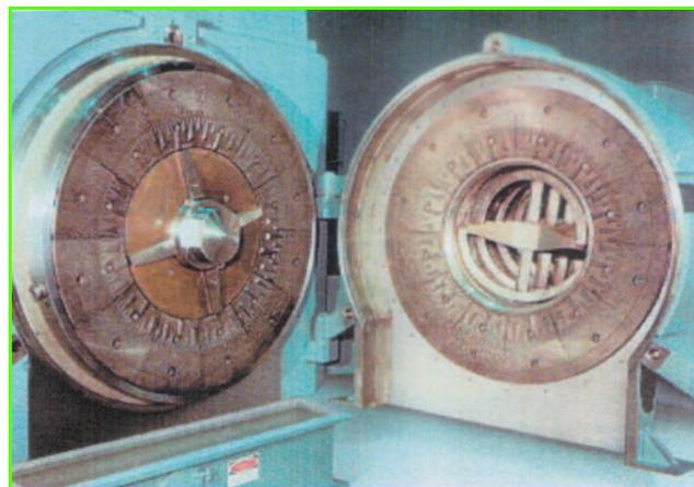
Figure 1 - Photographie d'un défibreur à disques ouvert.
