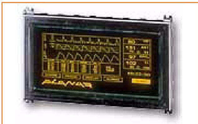
Figure 4 - Écran Planar 552 256-Q2 ICEBrite (552x256 pixels, diagonale 6,3"). Luminance 38 cd/m<sup>2</sup>. Contraste : 14 :1 sous 500 lux à 120 Hz.
