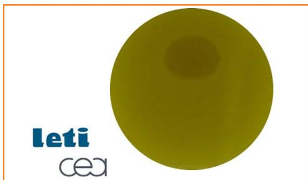
Figure 4 - Substrat 4H-SiC monocristallin de 35 mm de diamètre.
