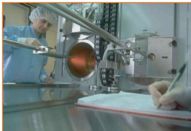
Figure 5 - Poste de chargement des substrats SiC sur un équipement d'épitaxie SiC (Epigress).
