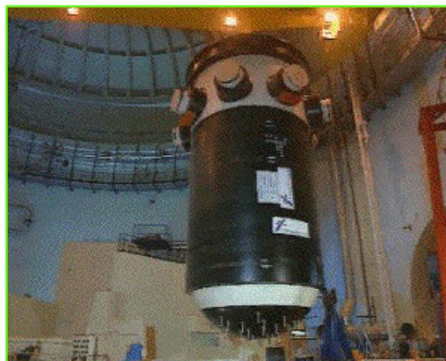
Figure 2 - Cuve d'un réacteur à eau sous pression.
