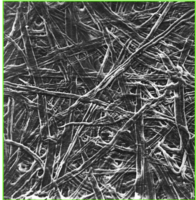
Figure 4 - Image au microscope électronique d'une surface de papier d'environ 1 mm<sup>2</sup>.
