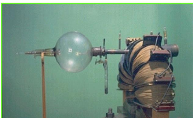
Figure 3 - Premier spectromètre de masse d'Aston (1877-1945).
