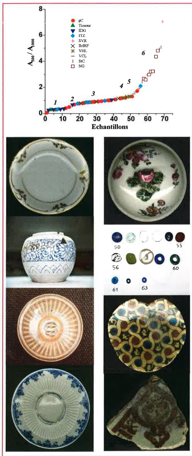
Figure 4 - Courbe maîtresse du rapport des massifs de déformation Si-O ( A_{500} ) et d'élongation ( A_{1000} ) mesurant le degré de polymérisation du verre et donc sa température de fusion pour un vaste ensemble d'émaux et de verres des premiers siècles de notre ère à aujourd'hui : gC, verres de Carthage ; Timour, émail bleu d'une brique du mausolée de Bibi Khanum à Samarcand ; IDG : glaçures de poteries islamiques de Dougga, ITZ : de Termez et du Sind (Route de la Soie) ; SVR : couvertes de porcelaines de Sèvres ; IMRF : glaçures et émaux de productions d'Iran et de Syrie ; VHL : émaux céladon de Ha Lan, Nord-Vietnam ; VCL : couvertes de porcelaines de Chu Dâu Nord-Vietnam ; StC : émaux des manufactures de Saint-Cloud et NG production moderne d'émaux de pâte dure. Photos d'objets ayant servi à construire la courbe : de haut en bas, à droite, porcelaine dure du XVIII e , France, du XV e siècle, Vietnam, céladon de Hà Lan, XIV e siècle, Vietnam, émaux de pâte tendre de la Manufacture de Saint-Cloud (décor bleu sous-émail) et à gauche, de Mennecy (XVIII e ), perles et anneaux de verre de Carthage (<IV e siècle), céramiques islamiques provenant des fouilles de Fostat (Égypte, mais alors importées, -XIV e siècle). La céramique du bas est une céramique lustrée, une dernière cuisson provoquant la diffusion puis la précipitation de nanocrystallites d'argent et/ou de cuivre (©photos Ph. Colombar, Coll. Particulières sauf Saint-Cloud et Mennecy, Musée national de Céramique, Sèvres).
