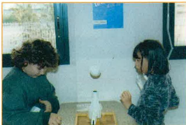
Figure 2 - Exemple d'expérience contre-intuitive illustrant l'effet Venturi : la « lévitation » très stable d'une balle dans le flux d'air d'un sèche-cheveux (Ébulliscence, Vaulx-en-Velin, janvier 2001).
