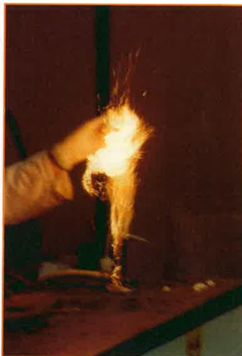
Figure 1 - Exemple d'expérience contre-intuitive particulièrement spectaculaire : la combustion du fer.
