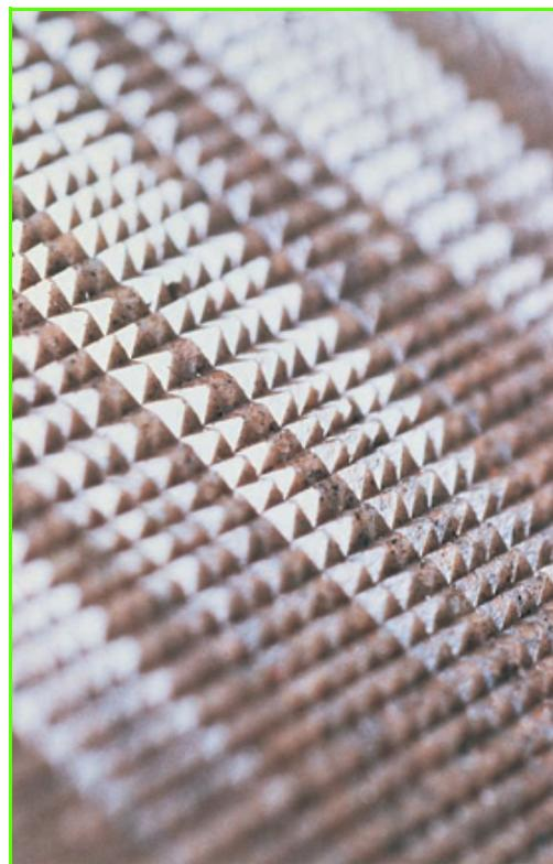
Photo 1 - La technologie de réplication illustrée (jusqu'à 300 pyramides/cm<sup>2</sup>) est avec le multicouches une technologie majeure de 3M. Elle est utilisée pour l'élaboration du Trizact pour le polissage des semi-conducteurs.
