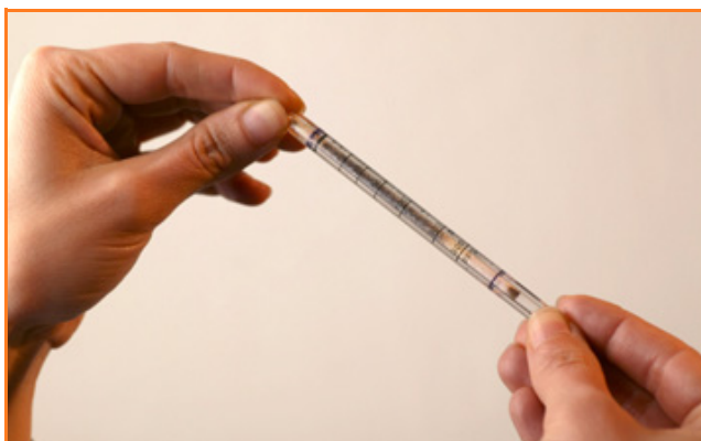
Figure 2 - Résultat d'une mesure effectuée par un élève après analyse de la solution B. ©Christian Morel. Tube réactif gasoil 0,5 - 5 \text{mg}\cdot\text{L}^{-1} (réf. : hydrocarbure d'essence 10/a n° 8101691).
