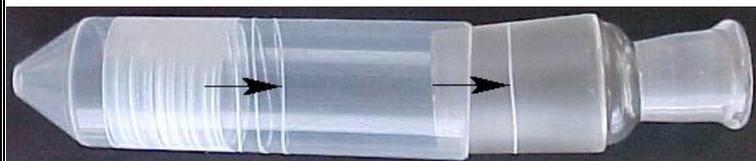
50 bagues en PTFE sur un tube pour un joint de 29 mm.
