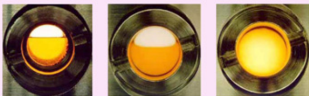
Figure A1 - Changement de phase du CO 2 jusqu'au CO 2 supercritique (de gauche à droite). Source : page Internet de l'équipe du Pr W. Leitner et coll., MPI Kohlenforschung, Allemagne.
