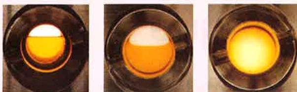
**Figure A1** - Changement de phase du CO<sub>2</sub> jusqu'au CO<sub>2</sub> supercritique (de gauche à droite). Source : page Internet de l'équipe du Pr W. Leitner et coll., MPI Kohlenforschung, Allemagne.
