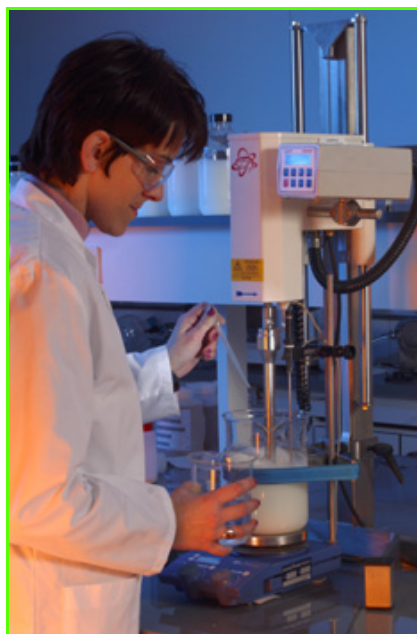
Mélangeur pour l'émulsification. Photo : Eliokem DR.
