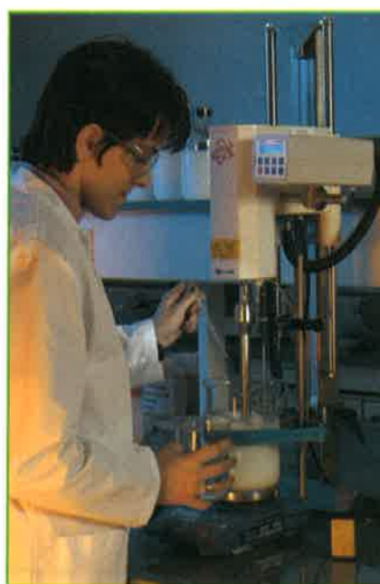
Mélangeur pour l'émulsification. Photo : Eliokem DR.
