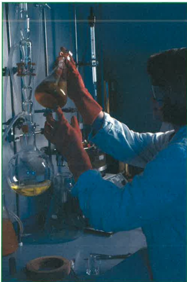
Séparation par chromatographie. Flash d'un mélange de tétrathiafulvalènes (chimie moléculaire à l'Institut des Matériaux de Nantes).
