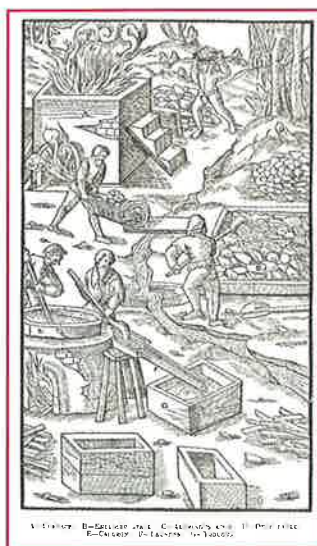
Le génie des produits au XVI e siècle. Production d'alun pour la teinture textile (d'après G. Agricola [35]).
