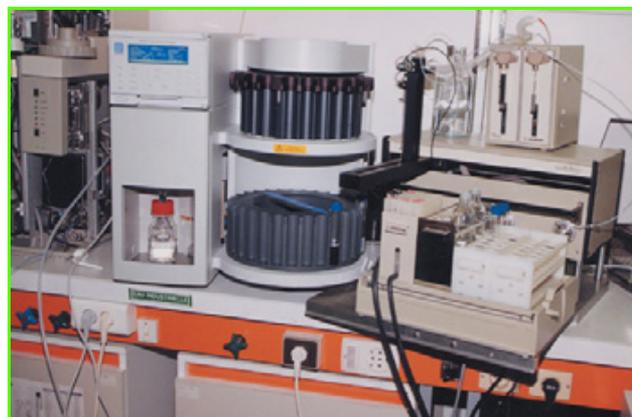
Figure 3 - Dispositif d'extraction des solides par solvant à chaud (le carrousel gris est le porteur des échantillons).
