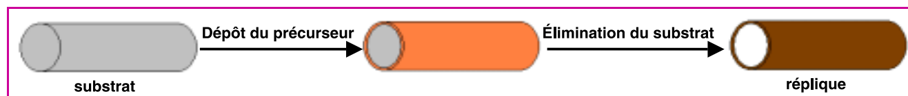
Figure 1 - Schéma du principe de la méthode des répliques.
