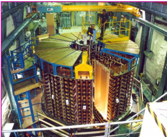
Figure 7 - Le détecteur NEMO dans le laboratoire souterrain de Modane.
