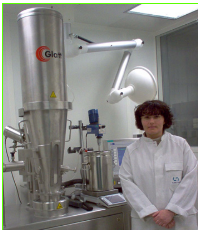
Figure 5 - Florence Guimberteau, responsable du service Recherche Galénique, travaille sur Micropump® depuis quatre ans. Elle se trouve à côté d'un lit d'air fluidisé qui sert à enrober la protéine d'une pellicule homogène. A chaque passage devant la buse, la protéine reçoit progressivement la solution d'enrobage sous forme de gouttelettes (photo : L. Joumel).
