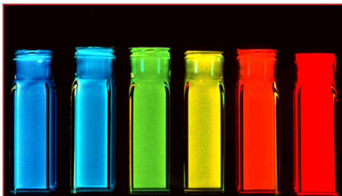
Figure 1 - Luminescence de nanoparticules de CdSe entourées d'une coquille de ZnS.
