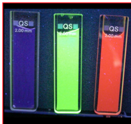
Figure 2 - Colloïdes luminescents de phosphate de lanthane sous irradiation UV.
