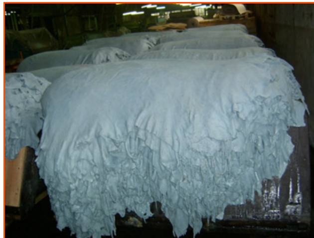
Figure 4 : Wet-blue en cours de mûrissement (©Tanneries du Puy).
