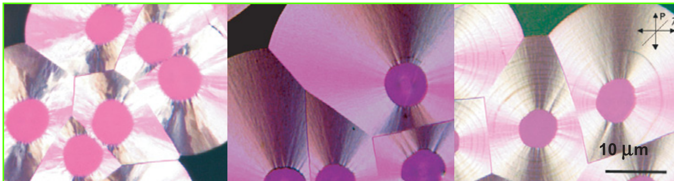
Figure 6 - Les trois grandes familles de pyrocarbures vues en microscopie optique au sein de composites. De gauche à droite : laminaire rugueux, laminaire sombre et laminaire régénéré.
